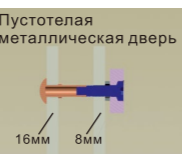
Пустотелая металлическая дверь Просверлите отверстие 8 и 16 мм
