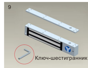
9 Используйте ключ-шестигранник, чтобы снять монтажную планку с замка
