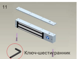
11 С помощью шестигранника прикручиваем замок к монтажной планке
